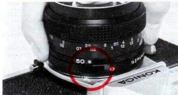
(27), tourner la partie chromée de l'objectif dans le sens inverse de la rotation des aiguilles d'une montre. Lorsque le point rouge de la monture coïncide avec celui du corps de l'appareil, l'objectif peut être dégagé.
