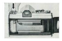
3 Ziehe genügend Film heraus und führe das Filmende in den Schlitz der Aufwickelspule (1) ein.
