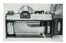
Schliesse die Kamerarückwand und spanne den Schnellaufzughebel, drücke anschliessend auf den Aus löseknopf 9 und wiederhole diese zwei Betätigungen bis die Zahl 1 des Filmzählwerkes 10 gegenüber der Filmzählwerkmarkierung zu stehen kommt.
