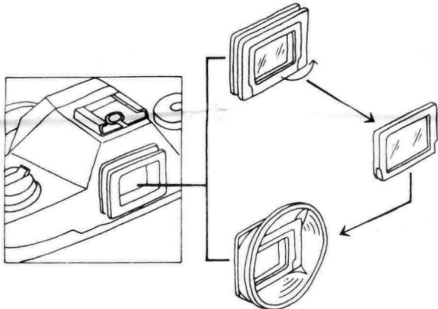
視度調整レンズ 2 とアイカップ 2 は、カメラのアイビース枠に差し込んで取付けます。併用するときは、視度調整レンズ枠の下側を指で押し上げて外し、アイカップの枠に差し込んで取付けます。
