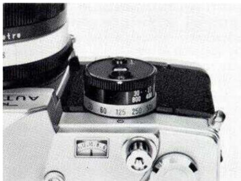
Die Blende dient dazu, die Menge des auf den Film einfallenden Lichtes zuregulieren und den Tiefenschärfenbereich zu bestimmen. Bei der **Revue Auto-Reflex** wird die richtige Blende automatisch gewählt, wenn die Filmeempfindlichkeit und die Verschlusszeit eingestellt sind. Diese Blende wird durch den Zeiger im Sucher angezeigt. Das Objektiv mit dem vollautomatischen Blendenmechanismus wird nur in dem Moment der Auslösung auf die gewählte Öffnung eingestellt und dann sofort wieder voll geöffnet.
