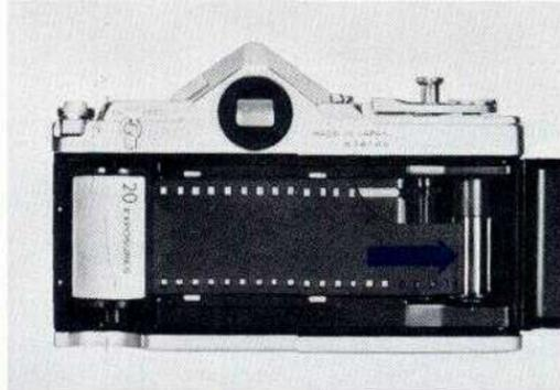
3 Stecken Sie den Filmfang in die Aufwickelspule 36
